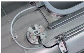
Les valeurs d'humidité résiduelle sont relevées de manière précise et numérique dans le tambour de pressurage grâce à un capteur spécial. La valeur actuelle est affichée à la fin de chacun des paliers de pression sur le grand écran tactile de la commande du presseur et les valeurs relevées peuvent être ensuite analysées. Le
