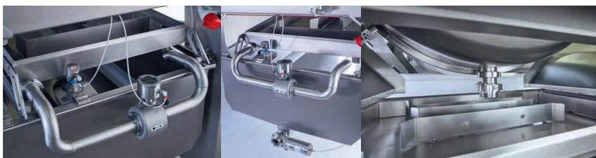
NOUVELLE GÉNÉRATION: L'évacuation intelligente du jus est assurée par une construction spéciale du bac à jus qui est doté d'un système de capteurs intégré ayant déjà fait ses preuves. Pendant toute la durée du pressurage, l'écoulement du jus est surveillé et le cycle de pressurage est constamment optimisé. Ceci permet de garantir un processus de pressurage ultra-efficace avec un pressurage optimal et respectueux des raisins.
